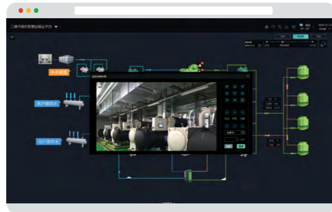
2. 平台自动弹出制冷站启动流程以及视频图像
